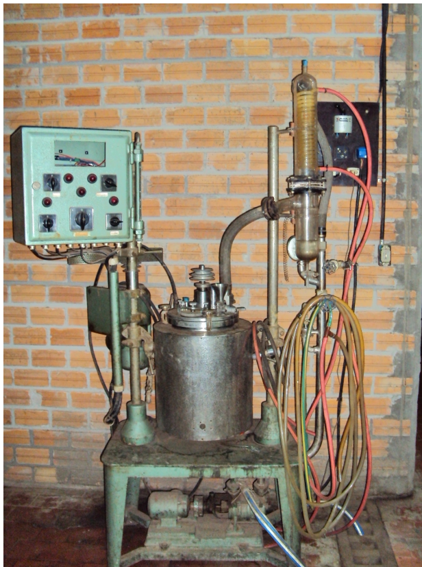
Sistema utilizado como evaporador
